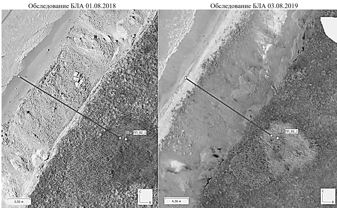
Рис. 2. Пример фрагмента разновременных ортофотопланов с поперечным профилем абразионного берега / Fig. 2. A fragment example of orthophotomaps taking maps place at different times with diametrical profiles of the abrasion bank
