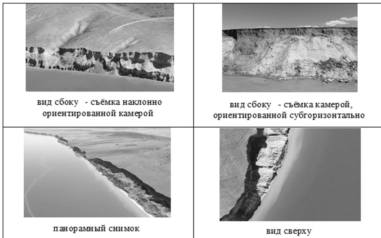
Рис. 1. Пример различных материалов съёмки с БЛА для определения типа берега / Fig. 1. Example of different materials from PLA (pilot-less aircraft) surveys to determine a bank type
