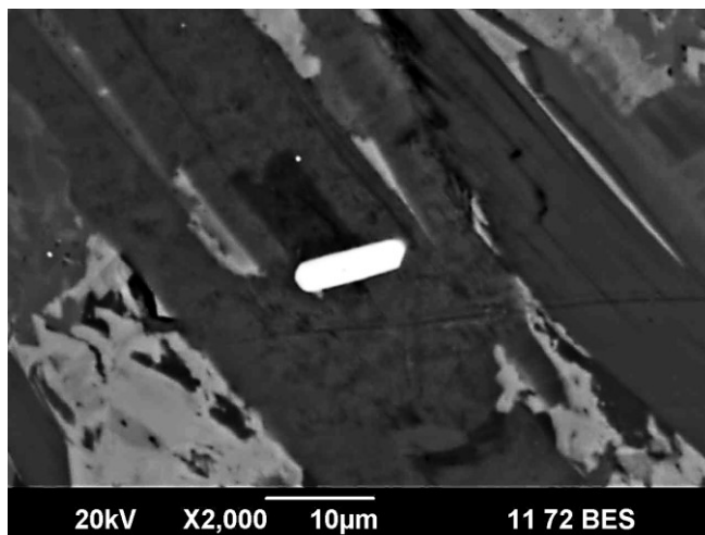
Рис. 2. Кристалл циркона (светло-серый) в сланце. BSE-фото, СЭМ JSM-6390LV / Fig. 2. Zircon crystal (light gray) in schists. BSE-photo, SEM JSM-6390LV
